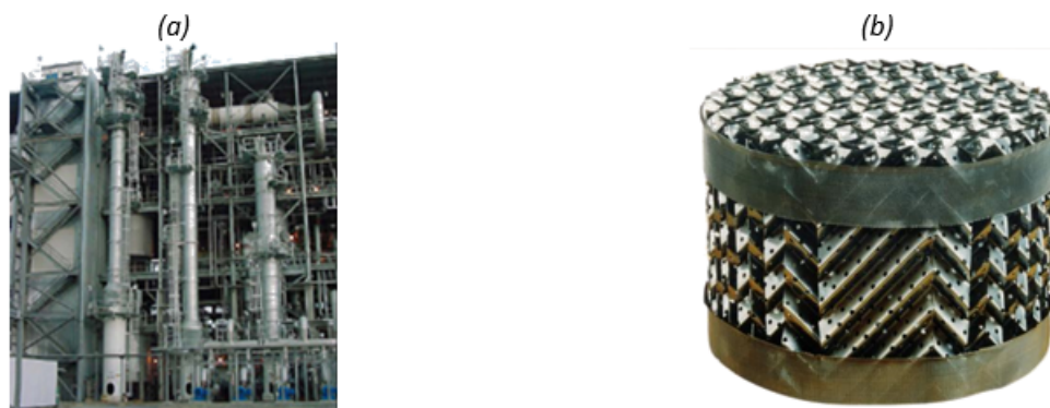
Figura 119 - Extração líquido-líquido na indústria. (a) Coluna de extração. (b) Recheio estruturado muito usado em colunas.
