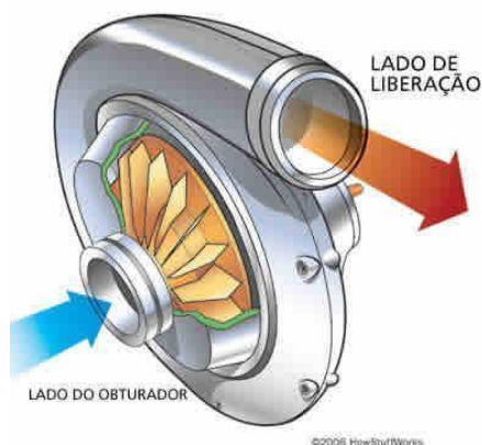
Figura 142 - Esquema de um Compressor Centrífugo (How Stuff Works. 2006).
